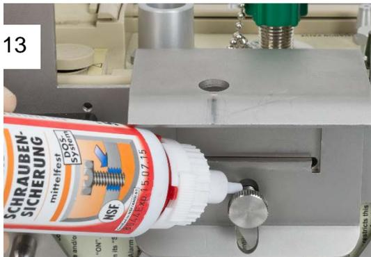
Setzen Sie nun die Schraube an und bringen sie den Schraubensicherungsack\* am Gewinde der Schraube an. Schrauben Sie nun die Schraube mit einem **Drehmoment von mind. 7,0 Nm fest.**
